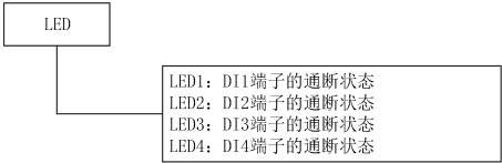
图7-3 开关量输入端子状态
